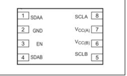
MSOP-8, SOIC-8 (Top View)
