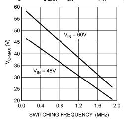
Figure 15.  $V_{O-MAX}$  vs  $f_{SW}$ , LM3402HV ( $T_A = 25$ °C)
