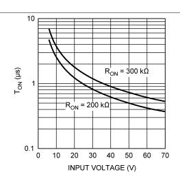
Figure 8.  $T_{ON}$  vs  $V_{IN}$  ( $T_A = 25$ °C)
