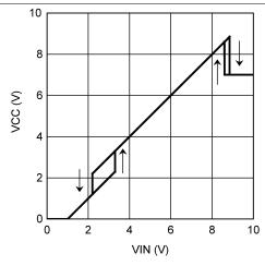
Figure 12.  $V_{CC}$  vs  $V_{IN}$  ( $T_A = 25$ °C)
