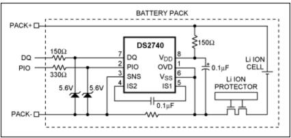
Figure 2. DS2740 installed in battery pack.
