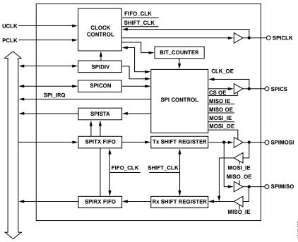
Figure 27. SPI Block Diagram
